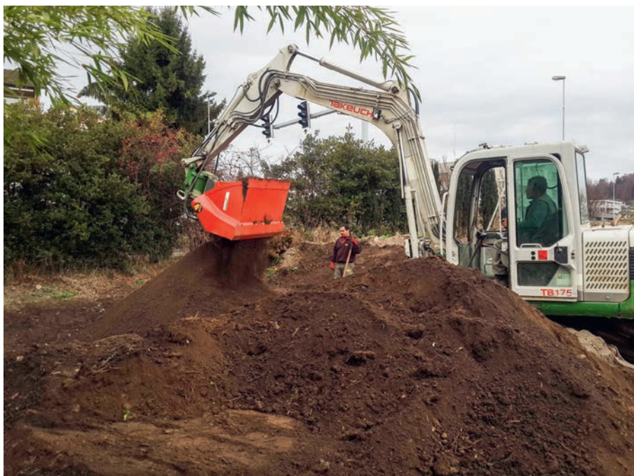
Links: Die Allu-Transformer der DL-Serie sind Anbaugeräte für kompakte Trägermaschinen und ideal zum Absieben von Böden und anderen Materialien.
