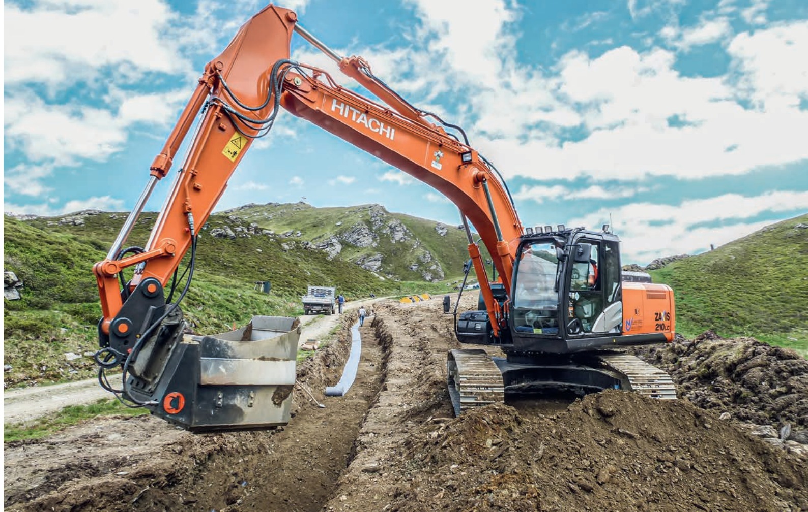
An Trägergeräte ab drei Tonnen passen die Schaufelseparatoren von Skancraft. Zum Herstellen von Flüssigboden gibt es optional ein Dosiergerät.
