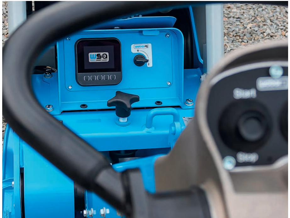
Moderne Hersteller verfeinern ihre leichten Verdichter mit der Möglichkeit, den Verdichtungsgrad des bearbeitenden Materials anzuzeigen. Bei Weber MT heisst diese Systematik Smart Assist.
