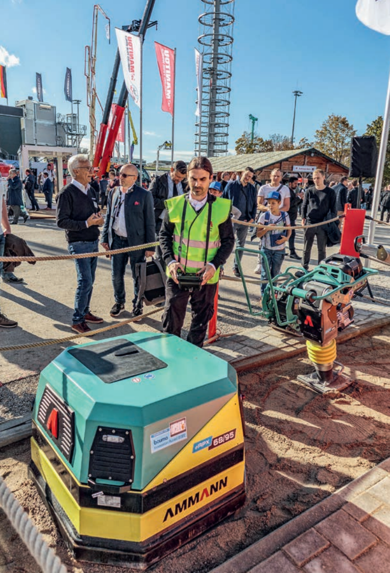
Eine ungewöhnliche Bauform hat die ferngesteuerte, elektrische eAPX 68/95 (3D-Compactor) von Ammann. Dank vier Erregereinheiten kann der Verdichter in allen Richtungen fahren und rotieren.
