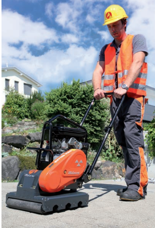
Hutter Baumaschinen führt in seinem «leichten» Verdichtungsprogramm den handgeführten Rollenrütter VR 85 (90 Kilogramm) vom Hersteller Mikasa für empfindliche Böden und Beläge.
