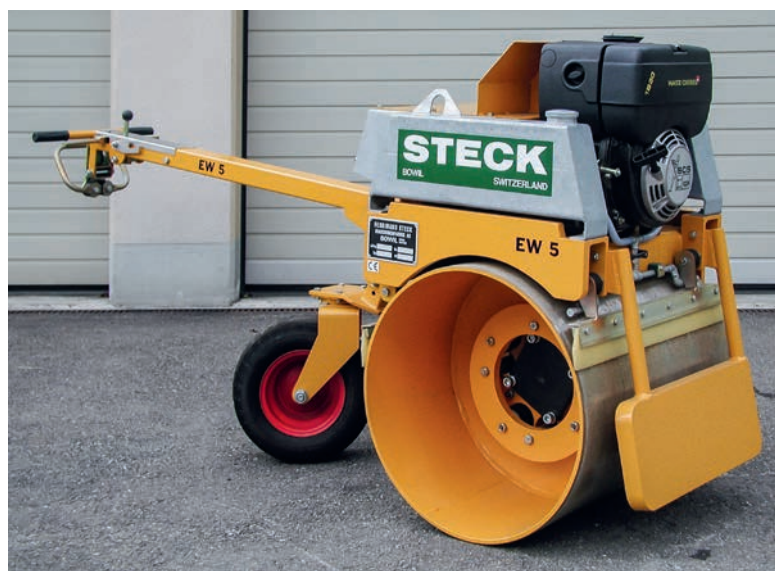
Handgeführte Einrollenwalzen (hier das Modell EW 5) sind eine Spezialität des Herstellers Steck. Sie haben einen hydrostatischen Fahrtrieb und sind unglaublich wendig.
