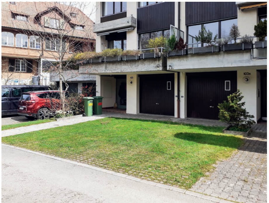
Begrünte Parkplätze fangen Regenwasser auf, das an heissen Tagen verdunsten kann. Foto: Silvia Oppliger
