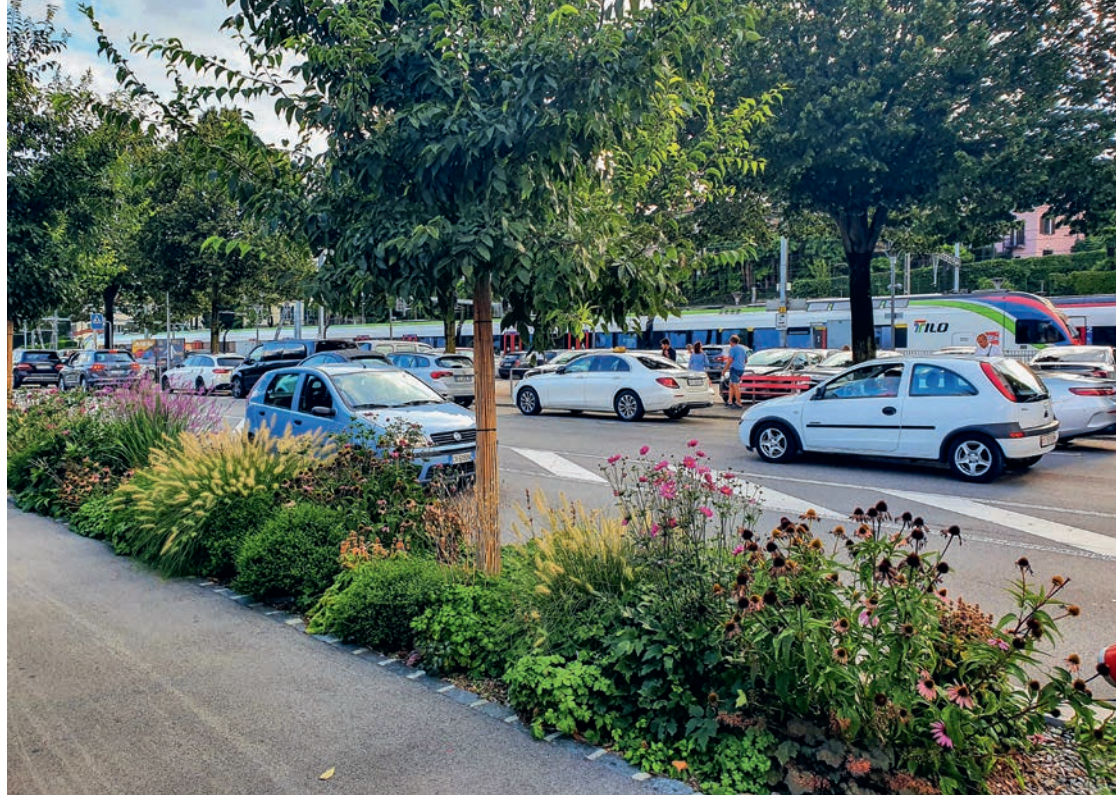
Grosszügig angelegte Pflanzbereiche neben den Verkehrswegen sehen gut aus, verbessern das Kleinklima und ermöglichen auch den Pflanzen ein Überleben bei Hitze und Trockenheit. Das Niederschlagswasser kann versickern und wird im Substrat in den Baumrigolen gespeichert.
