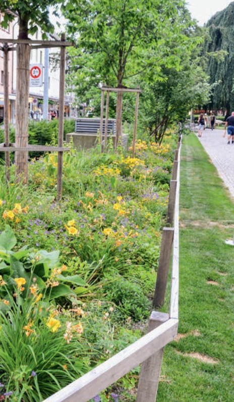
Grosszügig angelegte Pflanzbereiche neben den Verkehrswegen sehen gut aus, verbessern das Kleinklima und ermöglichen auch den Pflanzen ein Überleben bei Hitze und Trockenheit. Das Niederschlagswasser kann versickern und wird im Substrat in den Baumrigolen gespeichert.
