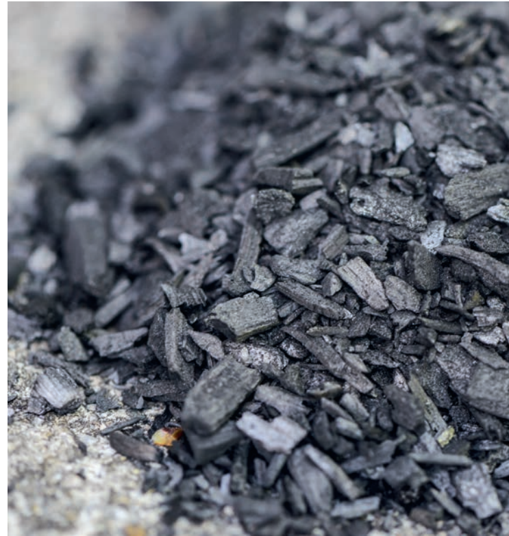
Eine qualitativ gute Pflanzenkohle weist eine grosse innere Oberfläche auf und hat sehr gute wasser- und nährstoffspeichernde Eigenschaften.
