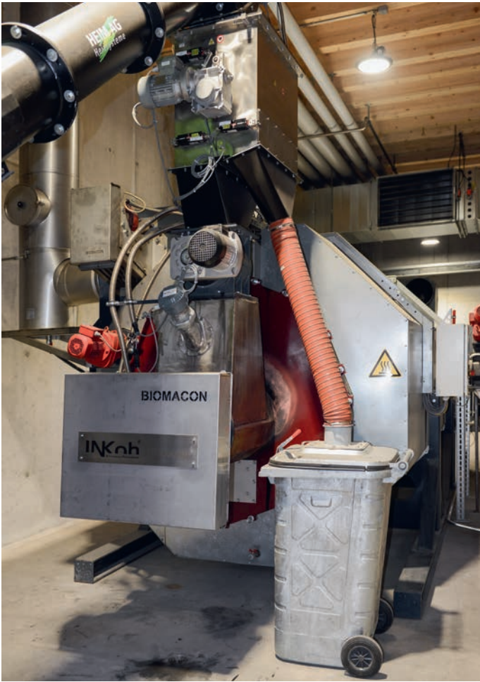
Bei einer Temperatur von rund 650 Grad entsteht im Pyrolyse-Ofen Pflanzenkohle.
