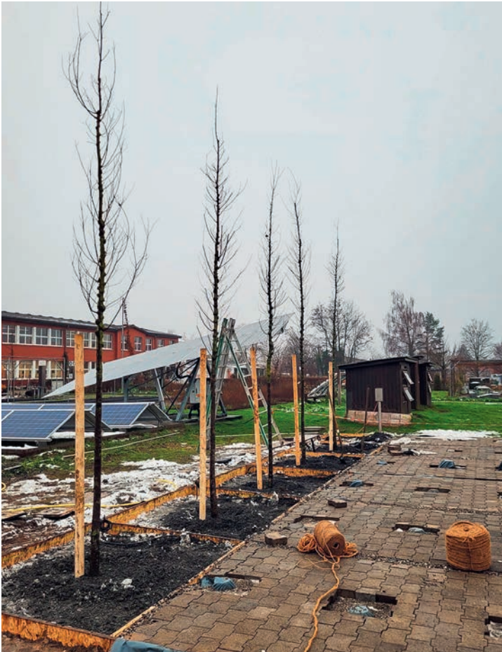
Die ZHAW testet in Wädenswil neue Baumsubstrate, die Pflanzenkohle enthalten. Foto: IUNR ZHAW
